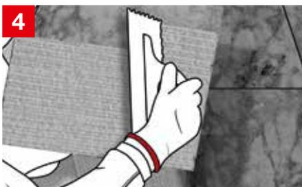
Je nach Auftrag wird auch auf der Plattenrückseite eine Kammspachtelung mit dem entsprechenden tubag Dünnbettmörtel aufgetragen
