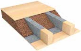
Zur gebundenen oder ungebundenen Verfüllung von Balkenzwischenräumen ohne Trittschalldämmung
