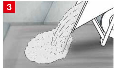
**3** Entsprechenden tubag Dickbettmörtel frisch in frisch auf die Haftbrücke auftragen. Bei Fußbodenheizung den Dickbettmörtel mit tubag FTD vergüten
