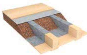
Zur gebundenen oder ungebundenen Verfüllung von Balkenzwischenräumen mit durchgehender Trittschalldämmung
