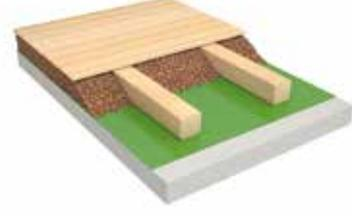
Als Dämmstoff zwischen Lagerhölzern auf Betondecken
