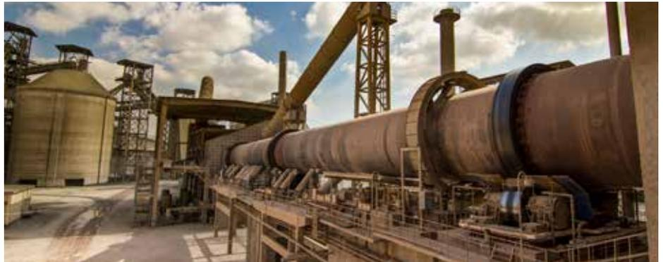
Kalkstein und Mergel werden bei mind. 1450°C zu Zementklinkern gebrannt und dann in Zementmühlen mit Zuschlagsstoffen wie Trass vermahlen. Zementäre Bindemittel werden erst seit Mitte des 19. Jahrhundert eingesetzt.
