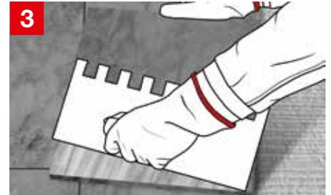
Auf der Rückseite des Belagelements wird eine Kratzspachtelung mit dem entsprechenden tubag Mittelbettmörtel aufgetragen
