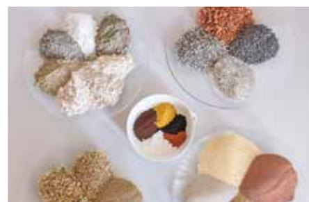
Auswahl von Bindemitteln (links oben), Fremd- und Eigensanden (Uhrzeigersinn) sowie Pigmenten (Mitte)
