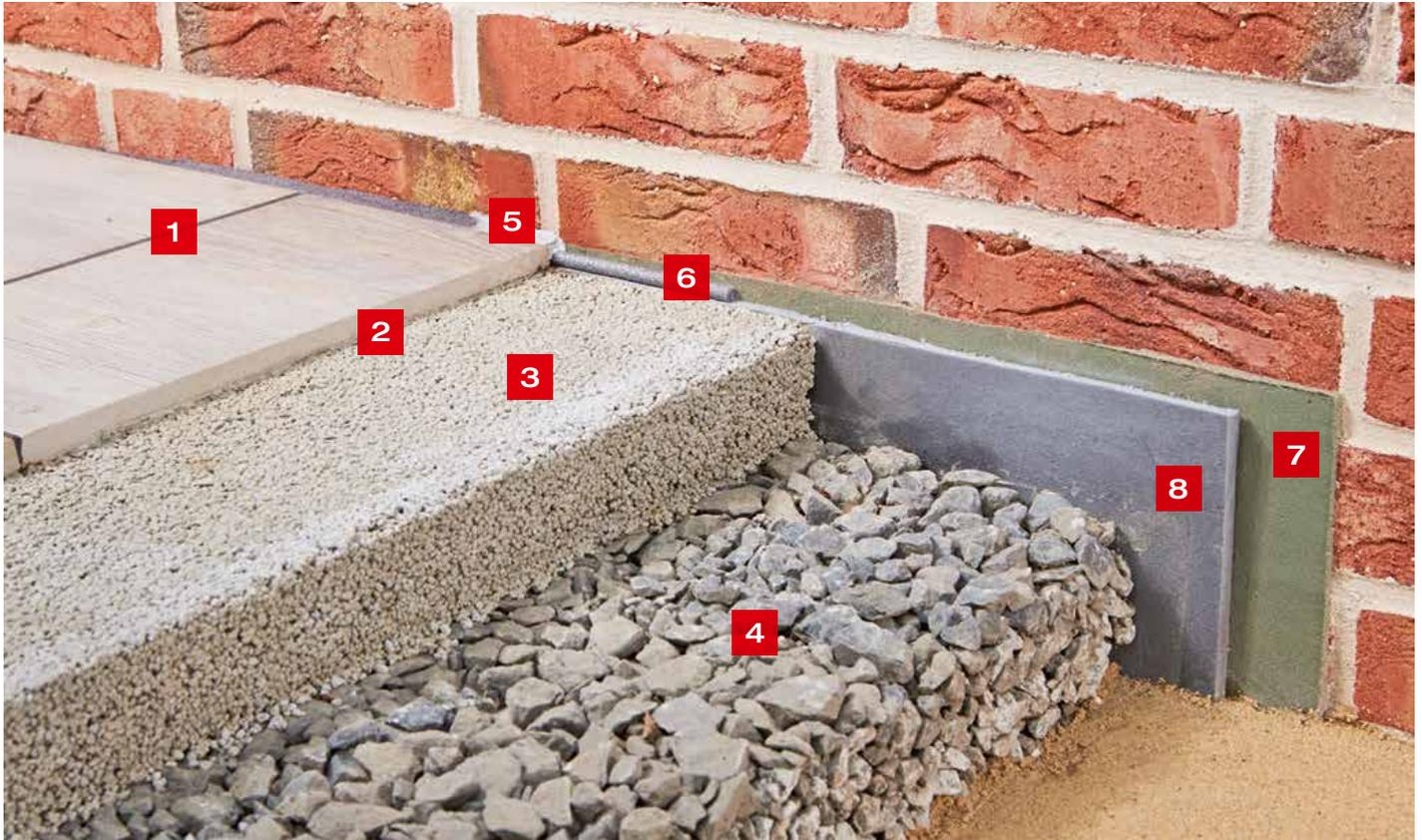
Kein Bauwerk ist spannungsfrei. Das gilt auch für befestigte Wege und Flächen im GaLaBau. Größere zusammenhängende Bereiche sind deshalb durch Bewegungsfugen zu unterbrechen. Auf diese Weise lässt sich das Risiko der Rissbildung deutlich verringern. Allerdings ist auch zu bedenken, dass Bewegungsfugen eine Schwachstelle im System darstellen.
