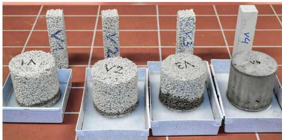
Test zur Wasseraufnahme von Trass-Dränbettungsmörtel (von links nach rechts):
